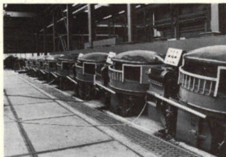
Afb. 3. Deze staaltrekbank maakt gebruik van acht trekfasen die elk afzonderlijk het aangeboden staal iets dunner maken.
