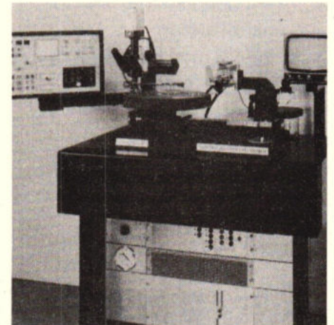
Afb. 2. Snijtafel met computer gestuurde groefafstand instelling.
